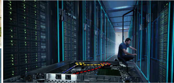
Stelaż serwerowy z bezpośrednim chłodzeniem cieczą
